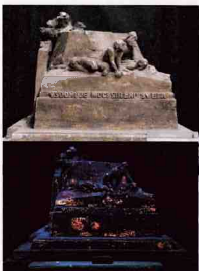
Průzkum modelu pomníku Jana Husa od Stanislava Suchardy – povrchové úpravy Foto ve viditelném světle / UV fluorescence
